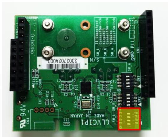
図 5 Launch Pad 接続時のスイッチ設定図
